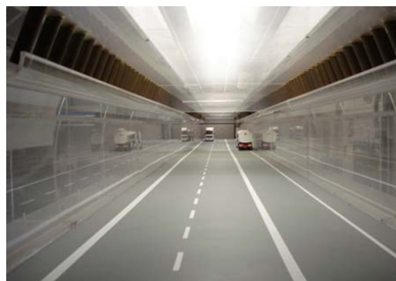
Wie in Wirklichkeit: Ein Blick in das Modell für eine Entrauchungsstudie in einem Tunnel.
