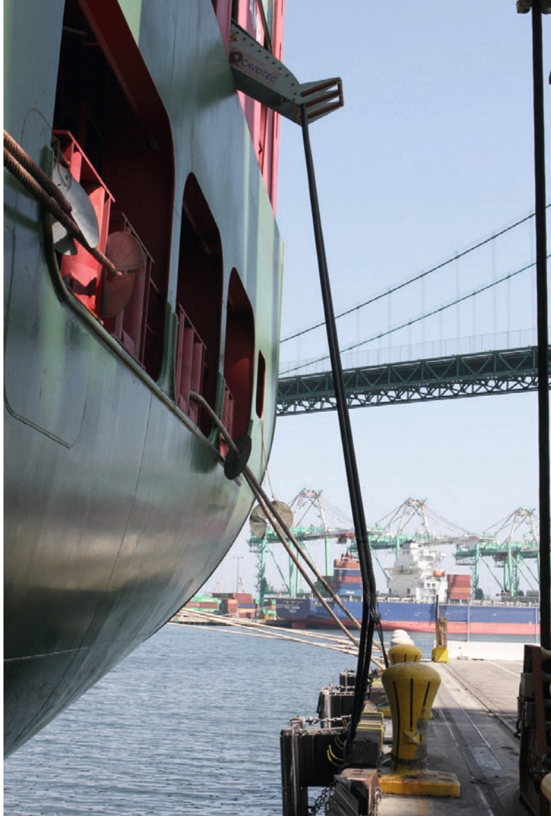
Bild 14 + 15 - Übergabe der Anschlussvorrichtung vom Schiff zum Kai
