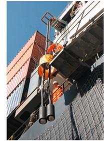
Bild 14 + 15 - Übergabe der Anschlussvorrichtung vom Schiff zum Kai
